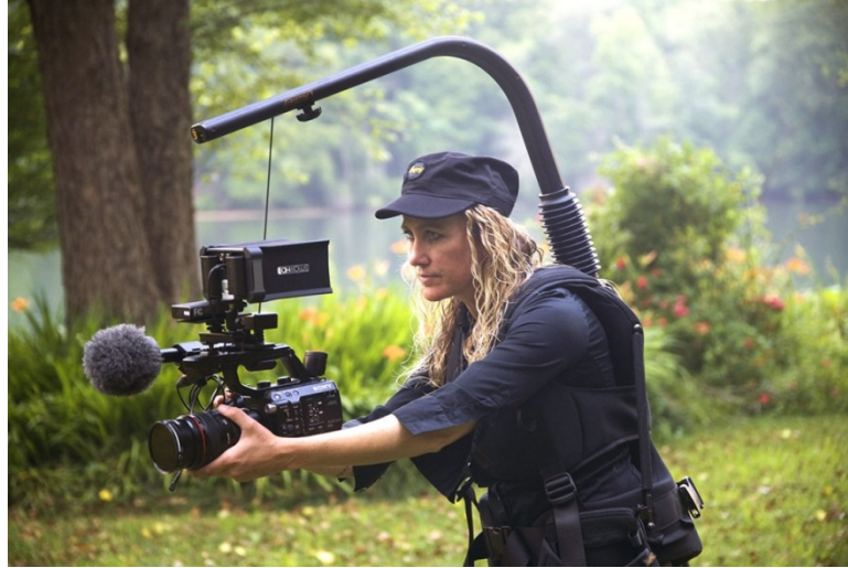
Şekil 50: Easyrig Aksesuarı ve Kullanım Şekli
