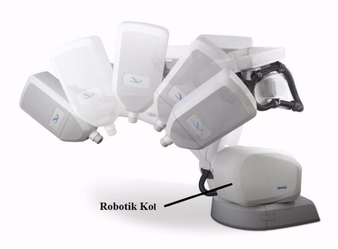
Şekil 2.9: Lineer hızlandırıcının hareketini sağlayan robotik kol
