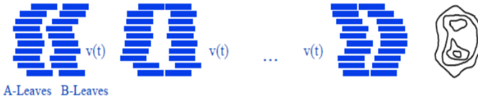
Sekil 4.4: Step and shoot ve dinamik IMRT tekniklerinde MLC hareketleri [45]
