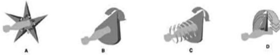
Şekil 2.9: A) Sabit Açılı YART B) Fan Beam YART C) Tomotherapy D) Cone Beam YART teknikleri için şematik çizimler [18].
