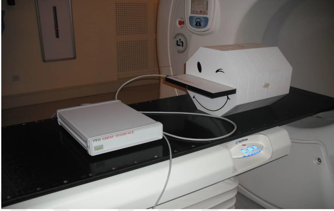
Şekil 7.7: 2D Array 729 iyon odası Octavius fantom setubü
