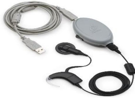
Şekil 2.6: Konuşma işlemcisinin programlama kablosuyla bilgisayara bağlanmış görüntüsü
