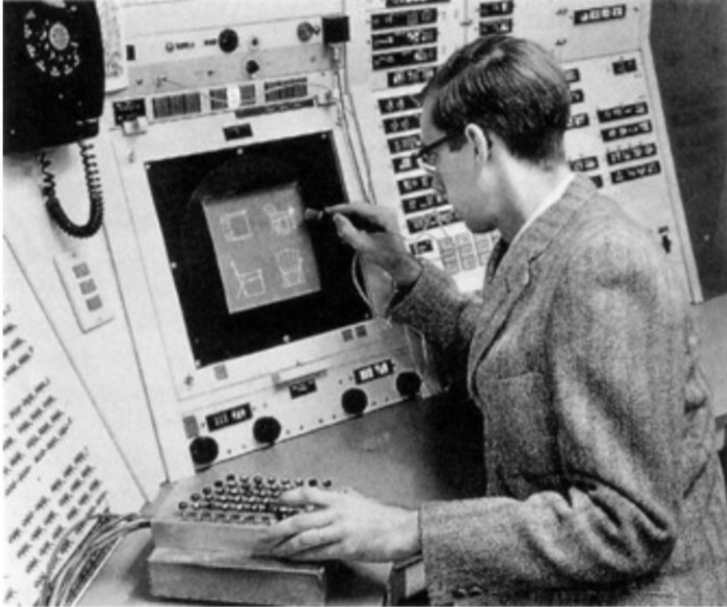
Resim 25. Ivan Sutherland’ın Işıklı Kalem Kullanarak Bilgisayar Ekranına Şekiller Çizmeyi Olanaklı Kılan Sketchpad Yazılımı
