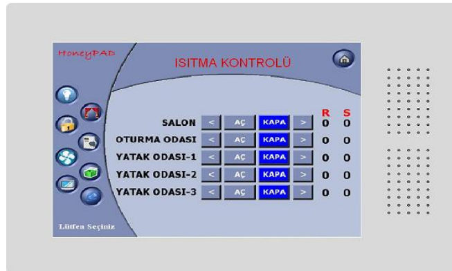
Şekil 3.1.: Isıtma ve Soğutma Sistemleri ana kontrol ekranı dokunmatik panelinizden http://www.akilliev.web.tr/akilli-ev-nedir/isitma-sogutma-kontrol-otomasyonu 1/5/2014
