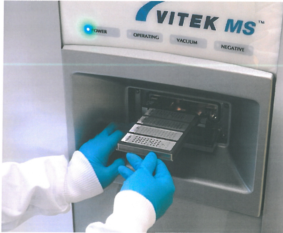
Şekil 3.4. VITEK®MS(bioMérieux) cihazı kaset okutma işlemi
