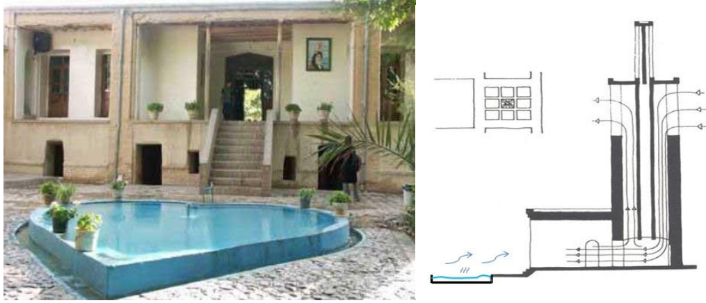
Şekil 4.5: Rüzgâr Bacası vakumu[4].
