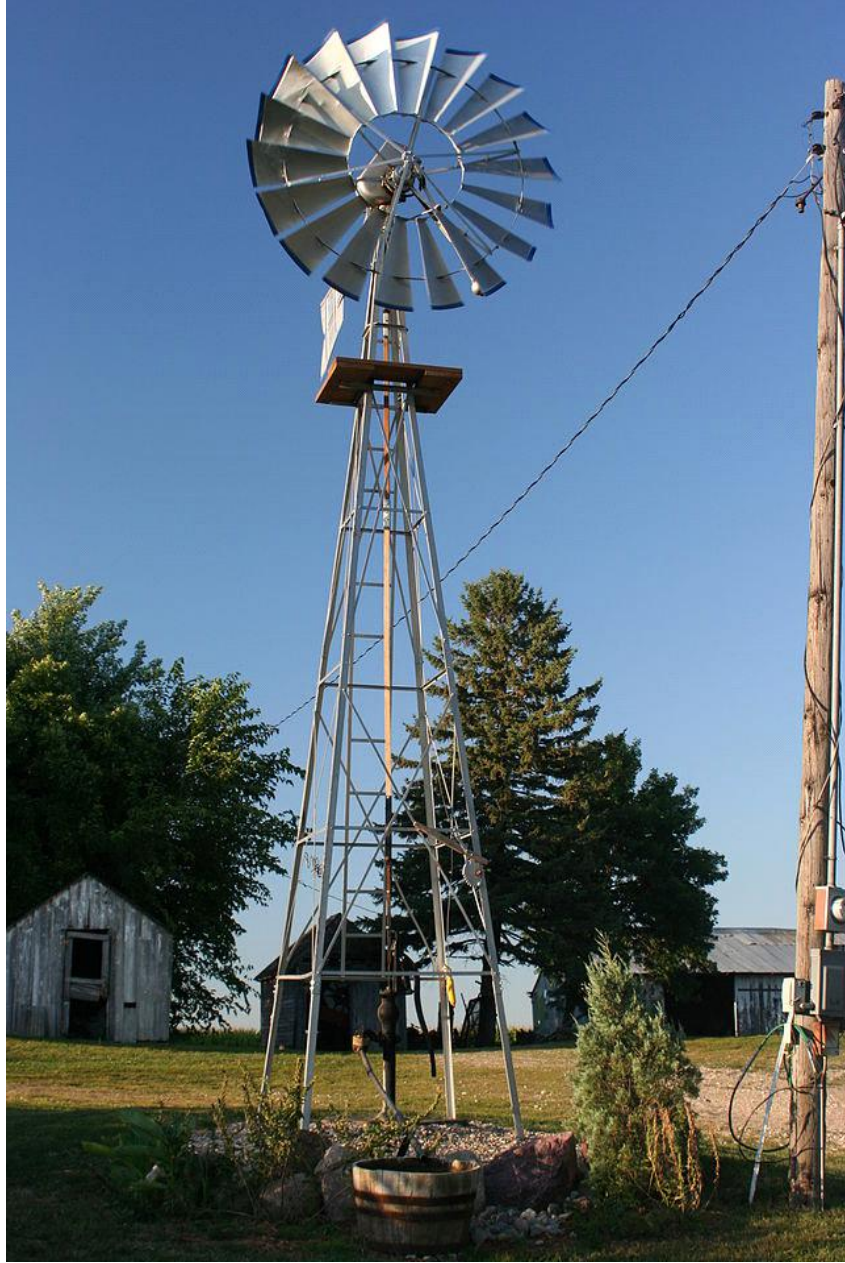
Şekil 3.42: Su Pompalayan Rüzgar Değirmeni (Franske, 2008)
