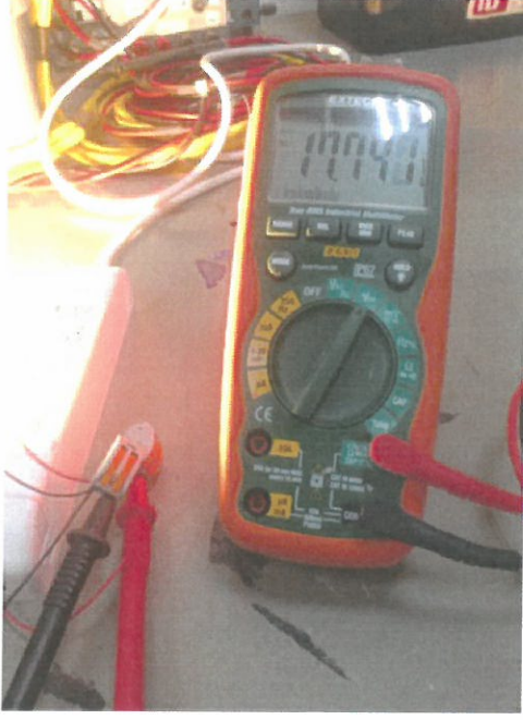
Şekil 4.19 : Led sistem tüketilen güç ölçme düzeneği
