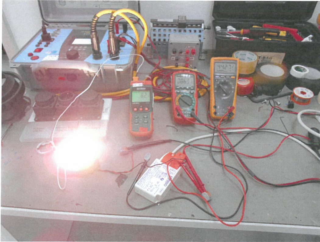
Şekil 4.4 : 500mA-630mA değerlerinde ölçülen led pcb yüzey sıcaklıkları
