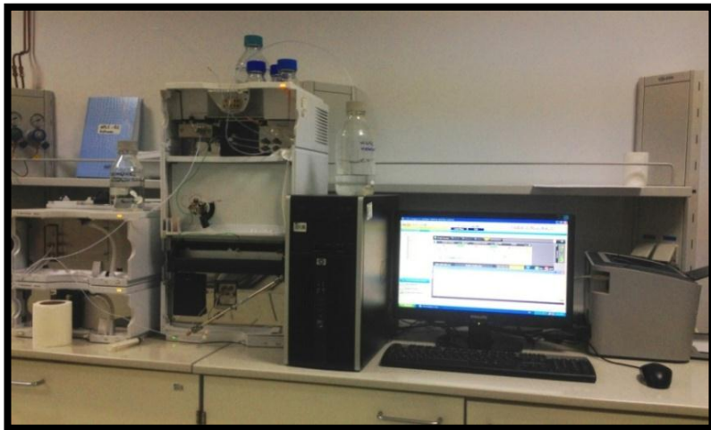
Şekil 3.2 : Agilent-1200 Series’ model Yüksek Basıncılı Sıvı Kromatografisi (HPLC)
