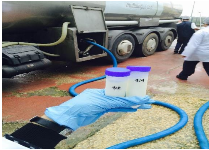
Şekil 3.1.1.2. Boşaltma hattı filtre drenajından örnek alma işlemi
