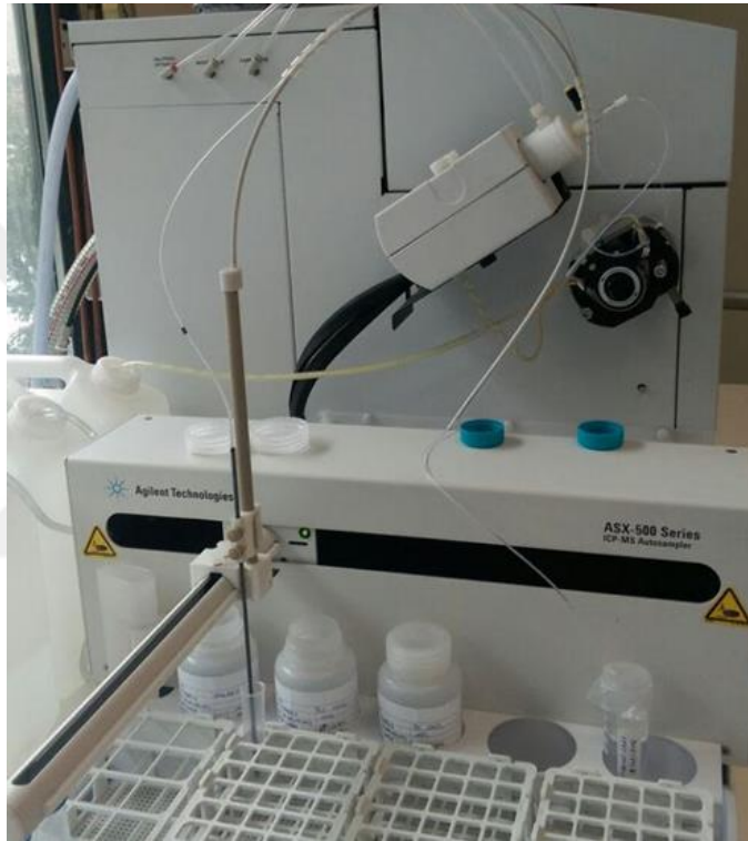
Şekil 3.3: ICP-MS cihazına numune çözeltisi yerleştirme
