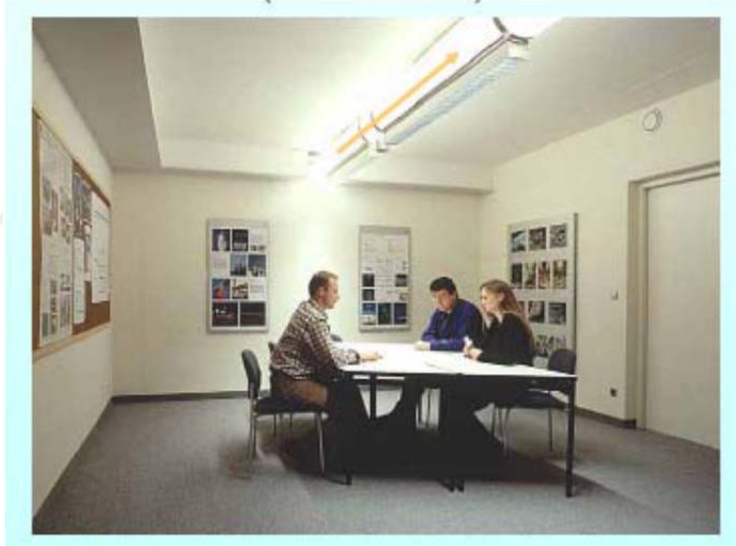
Şekil 4.23: Işık kılavuzu ile taşınan gün ışığının iç mekanda kullanılması (SEVİMLİ, 2011).
