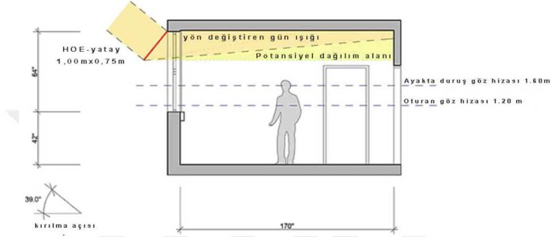
Şekil 4. 16: HOE sistemleri ile dik gelen ışınların odanın derinlerine yönlendirilmesi Holografik optik elemanlar ışığın yönlendirmesi için kırılımı kullanır. Bir kırılım ızgarasını biçimlendiren mikroskobik şeritler saydam bir filme basılır. Bu ızgara ışığın gelme açısını belli bir açıda yönlendirerek tasarlanabilir. Diğer bütün açılardan gelen ışınlar değiştirilmez. En sonda bu filmler çift camların arsına yerleştirilir (OKUTAN, 2008).
