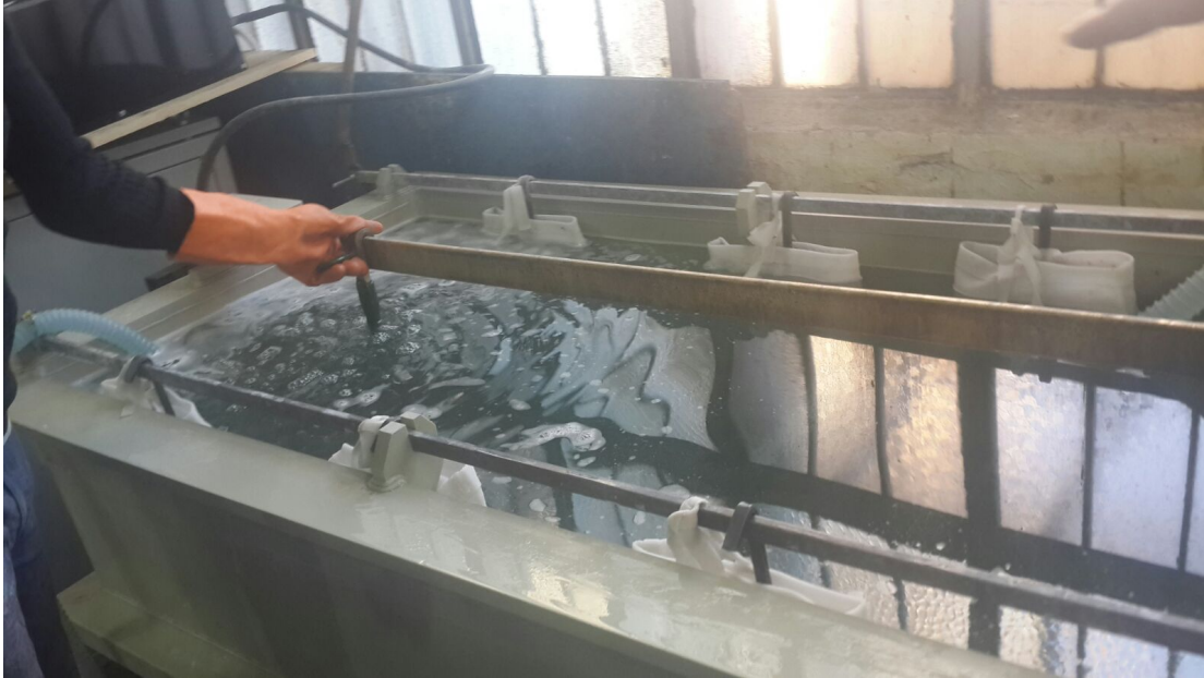
Şekil 7.3: Siyanürlü bakır kaplama tankı
