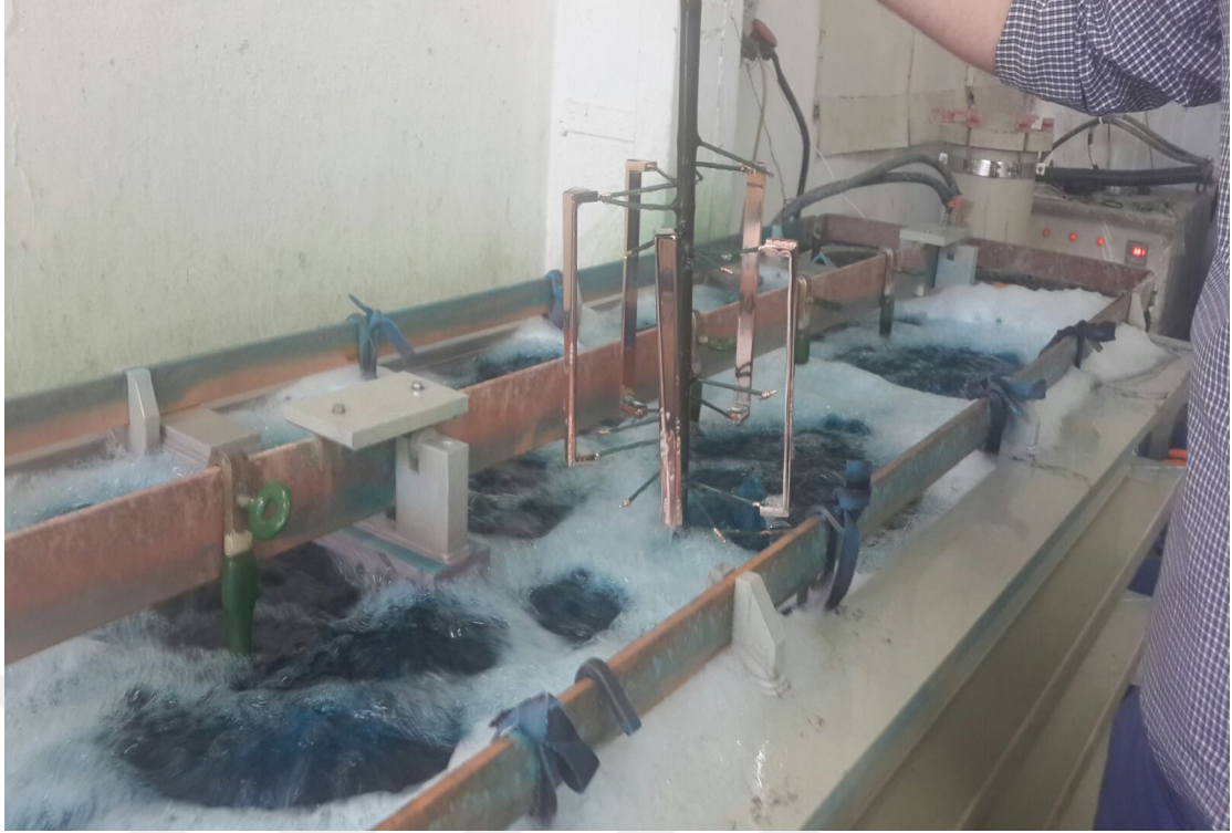
Şekil 7.7: Asitli bakır kaplama tankı
