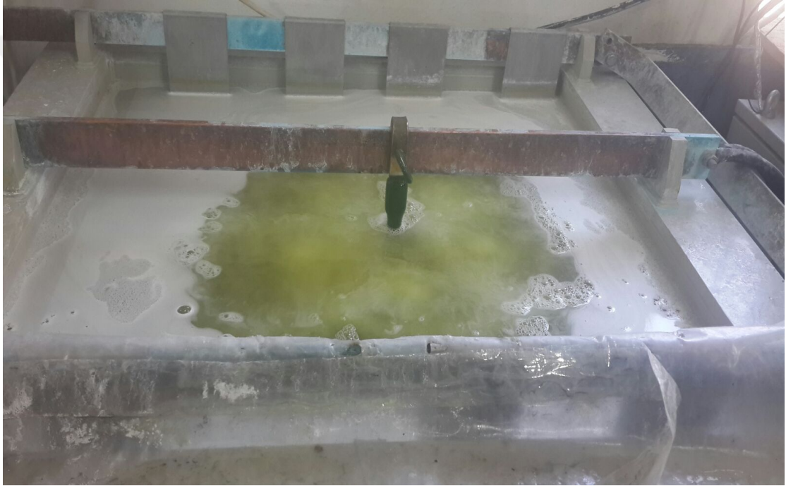
Şekil 7.2: Elektrolitik yağ alma tankı
