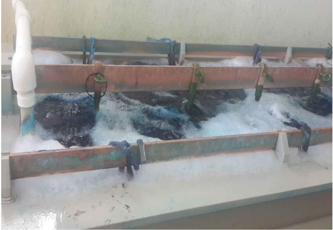
Şekil 7.1: Ultrasonik yağ alma tankı
