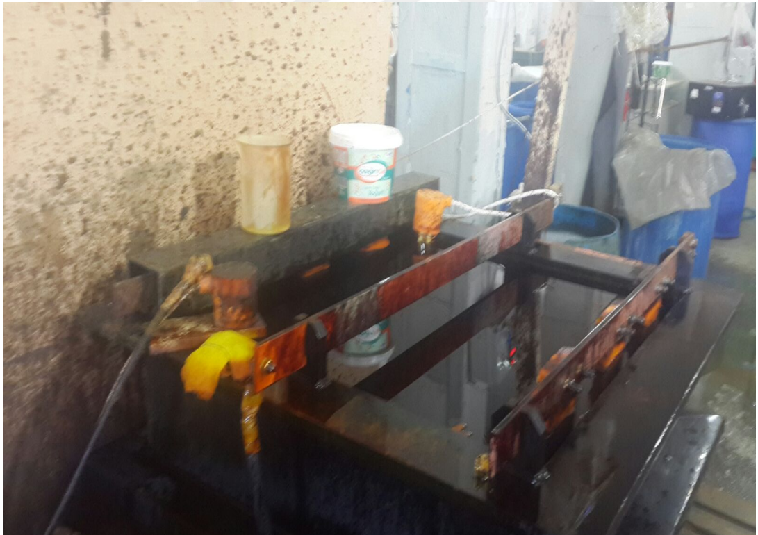
Şekil 7.10: Krom kaplama tankı
