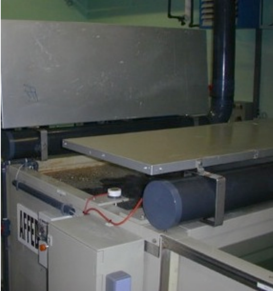
Şekil 7.4: Koruyucu kaplama tankı kapağı
