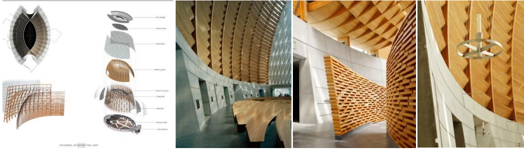
Şekil 4.23: Ahşap ve Camdan Yapılmış Katedral Detay Kesit [URL-10]
