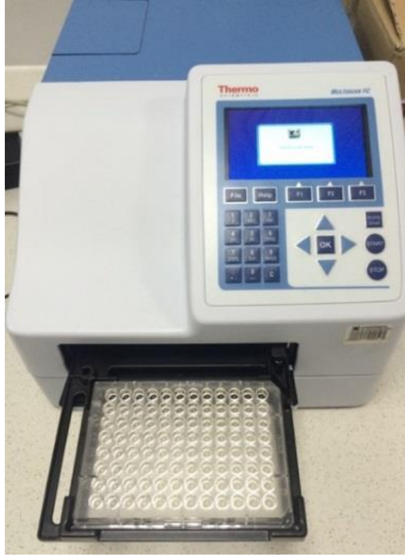
Resim 3.14: MultiScan spektrometre cihazı ve panelin yerleştirilmesi aşaması
