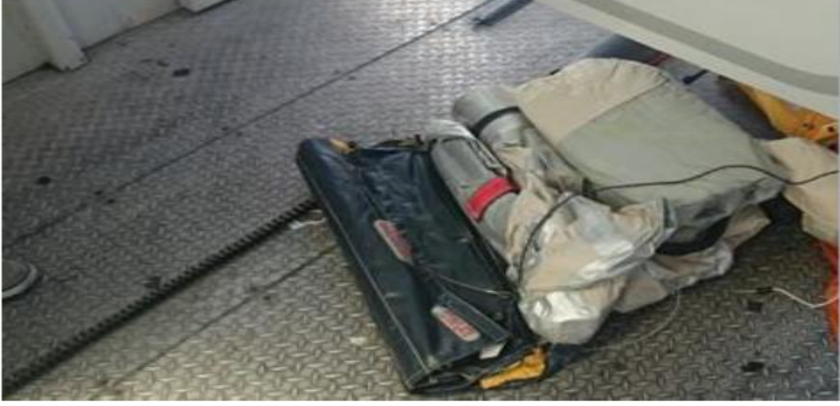
Şekil 5.9: Uçak kabinlerde slide paketinin düşerek zara görmesi
