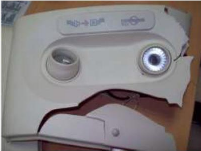
Şekil 5.1: Uçak kabinlerde türbülans sonucu oluşan hasar
