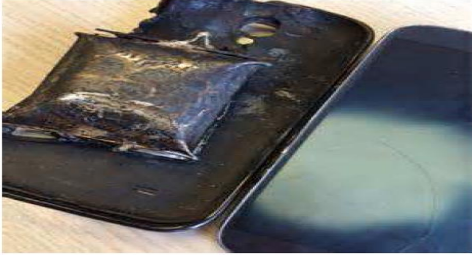
Şekil 5.12: Uçak kabinlerde pos makinesi bataryasının yanması
