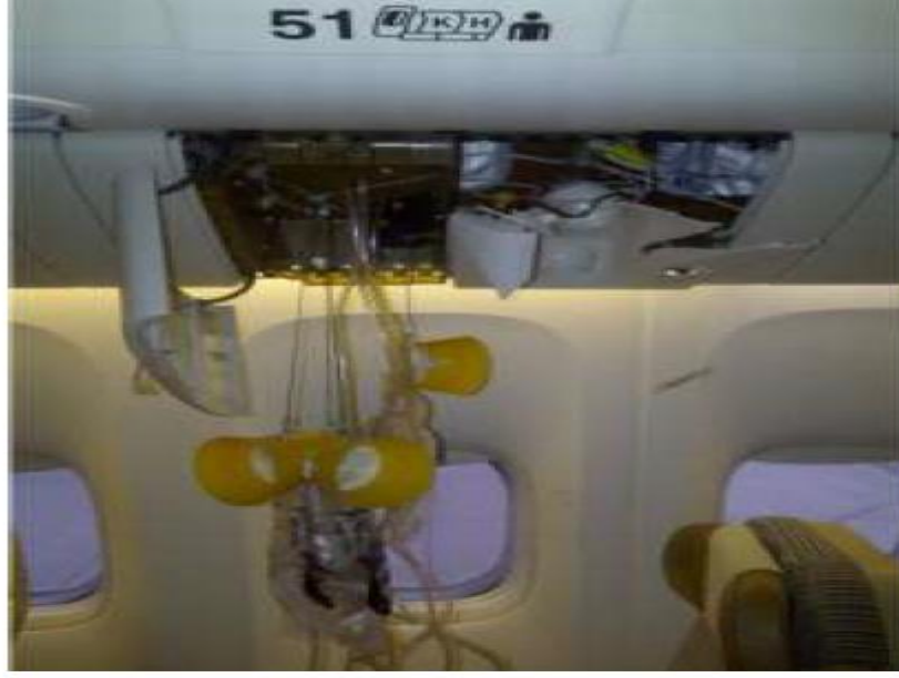
Şekil 5.2: Uçak kabinlerde türbülans sonucu maskelerde oluşan hasar
