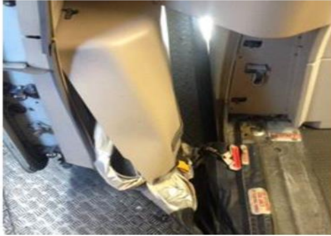
Şekil 5.7: Uçak kabinlerde slide paketinin düşmesi
