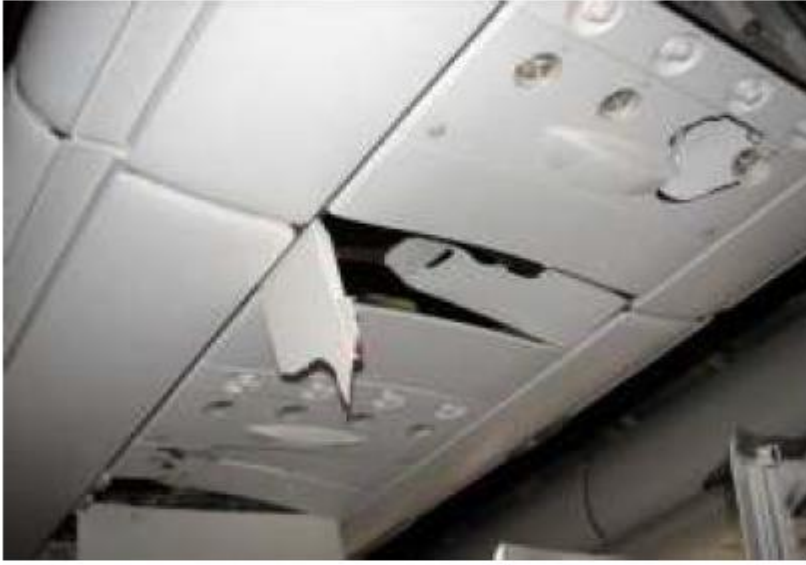
Şekil 5.4: Uçak kabinlerde türbülans sonucu aydınlatmada oluşan hasar
