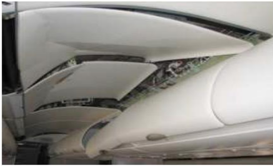
Şekil 5.3: Uçak kabinlerde türbülans sonucu baş üstü bagajlarında oluşan hasar
