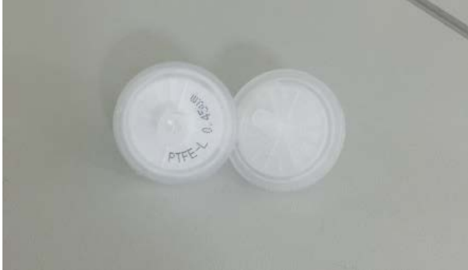
Şekil 3.2: HPLC Analizinde Kullanılan Şırınga Filtreleri
