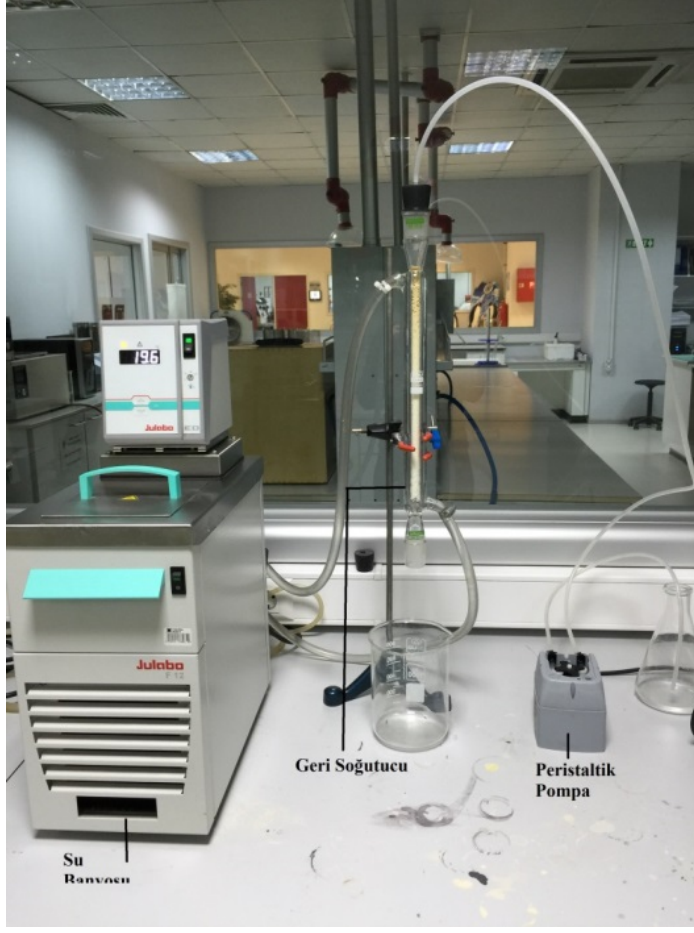
Şekil 3.3: Adsorbent Uygulaması İle Portakal Suyunda Limonin Acılığının Giderilmesi İçin Kurulan Sistem
