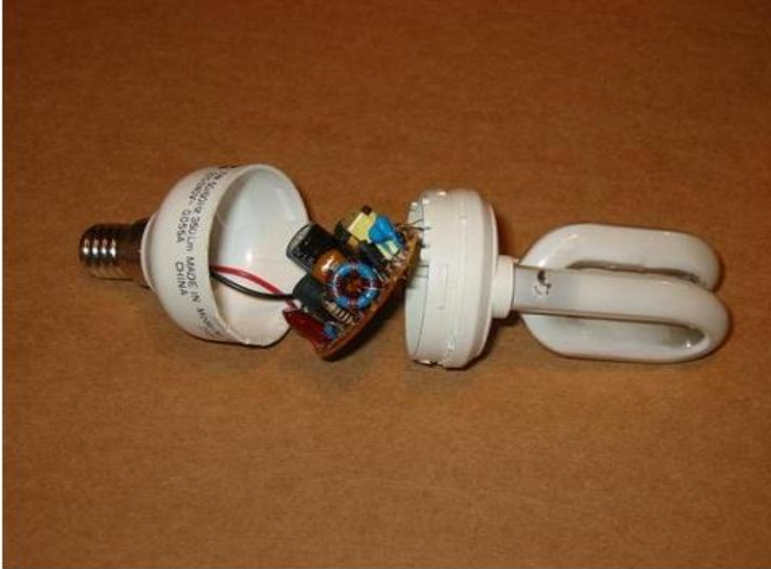
Şekil 4.2 Bir Bileşen Lambanın İçindekileri
