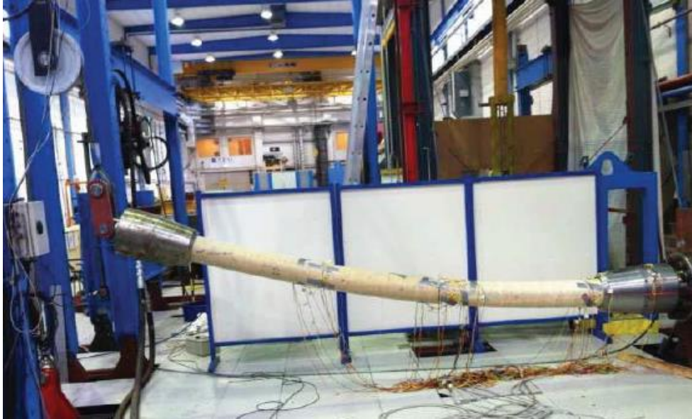
Şekil 4.5: Bir TKB numunesinde yapılan eğme yorulması testi (Van Onna ve diğ., 2012).
