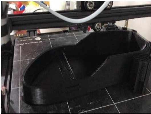
Şekil 2.9. 3B'li elektroterapi ajanlı AFO' nun yazdırılması
