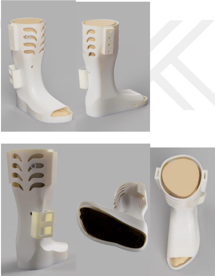
Şekil 2.7 3B'li elektroterapi ajanlı AFO'nun ilk modellenmesi
