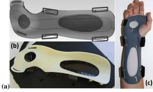
Şekil 1.13. (a) Ortezin 3B modeli, (b) 3B yazıcı ile imal edilen ortez ve (c) ortezin kullanımını (Palousek et al, 2014 ).
