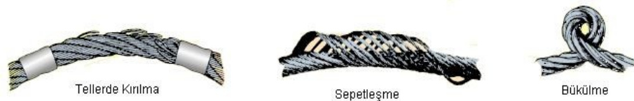
Şekil 3.17: Meydana gelen bazı hasarlar
