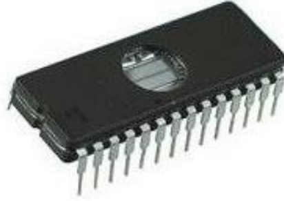
Şekil 5.10 : 8 bits EPROM bellek çipi
