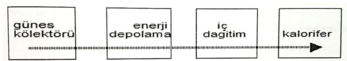
Şekil.5.1: Yukardaki şema binalardaki Güneş enerjisi sisteminin işleyişini gösteriyor.
