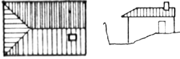
Şekil 4.48: Üç Omuz Çatı Tipi (Sümerkan, 1989)
