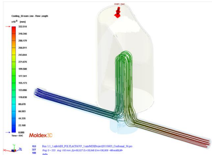
Şekil 2.6: Çeşmeli tip soğutma (Shiu, 2012)
