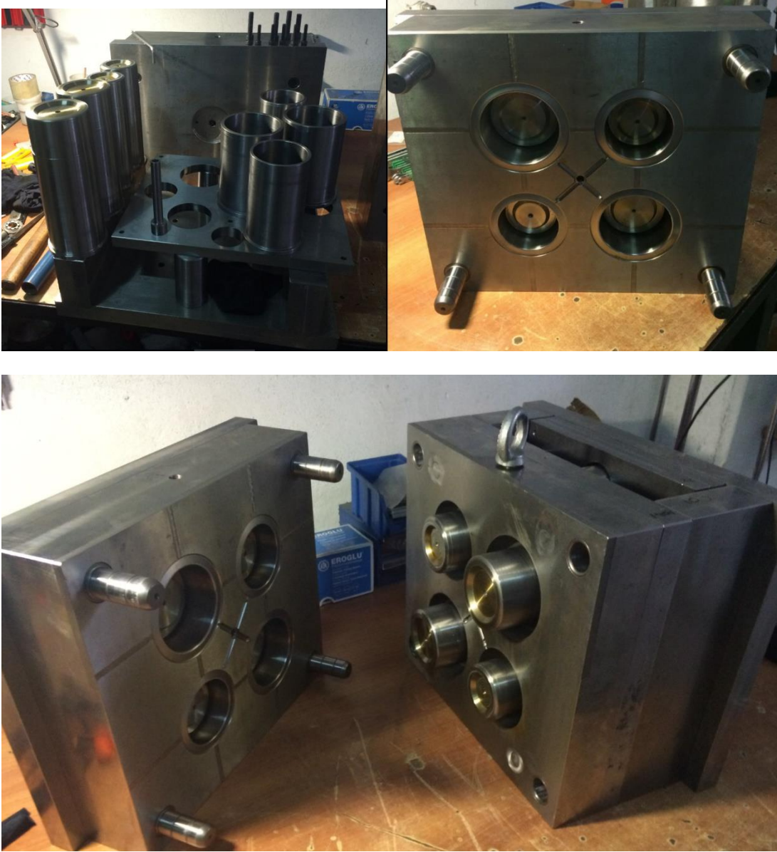
Şekil 7.1: İmalatı yapılmış olan kalıpların görselleri
