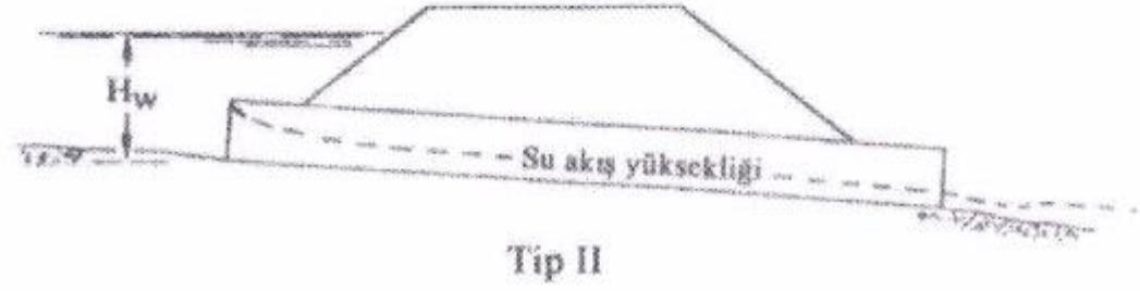
Şekil 6.3: Giriş kontrollü menfez işletme şartları
