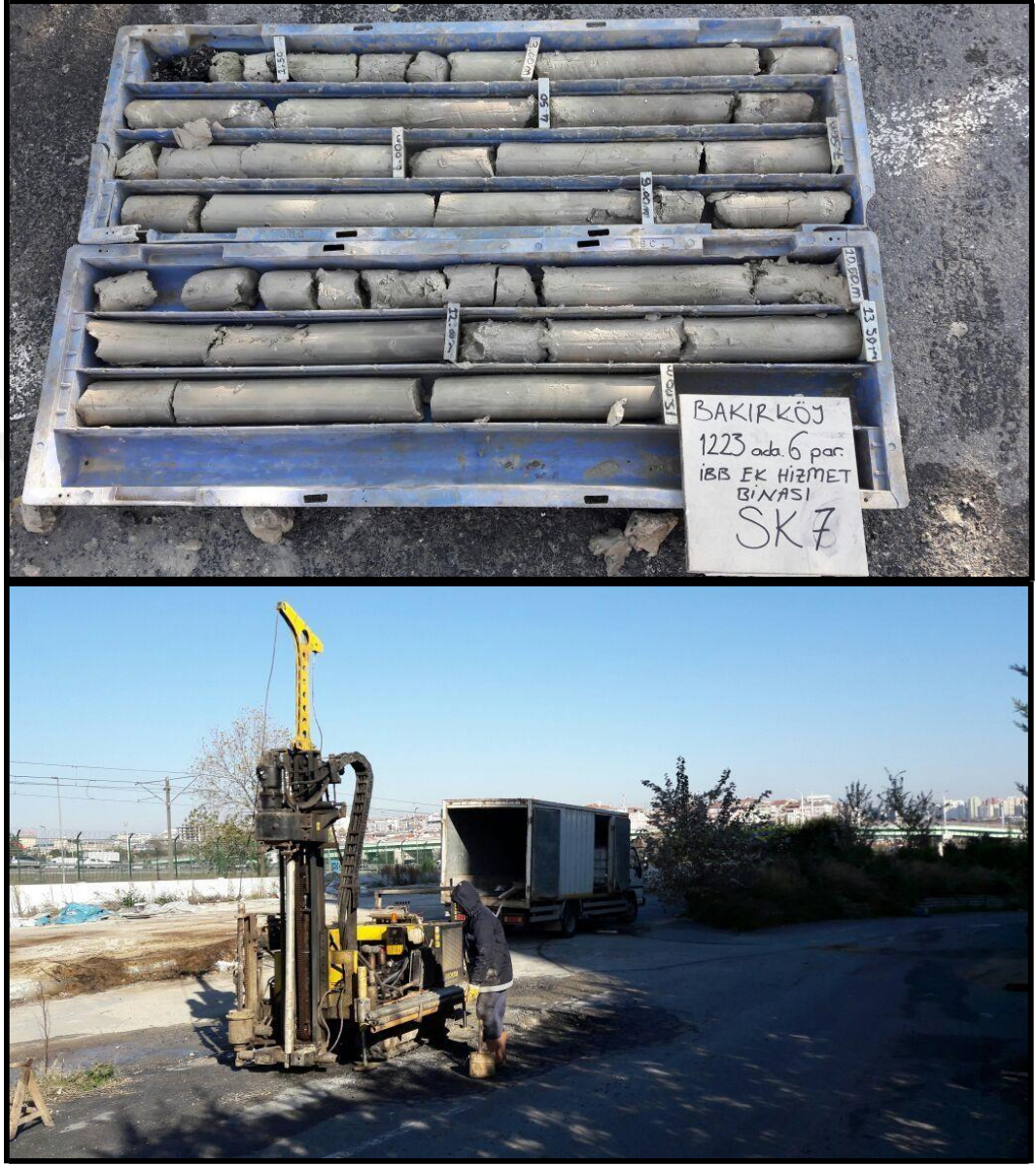
Şekil 3.10: SK 7 sondaj çalışması ve karot sandığından bir görünüm
