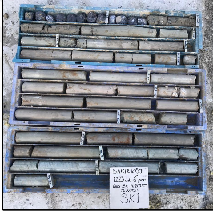
Şekil 3.4: SK 1 sondaj çalışması ve karot sandığından bir görünüm
