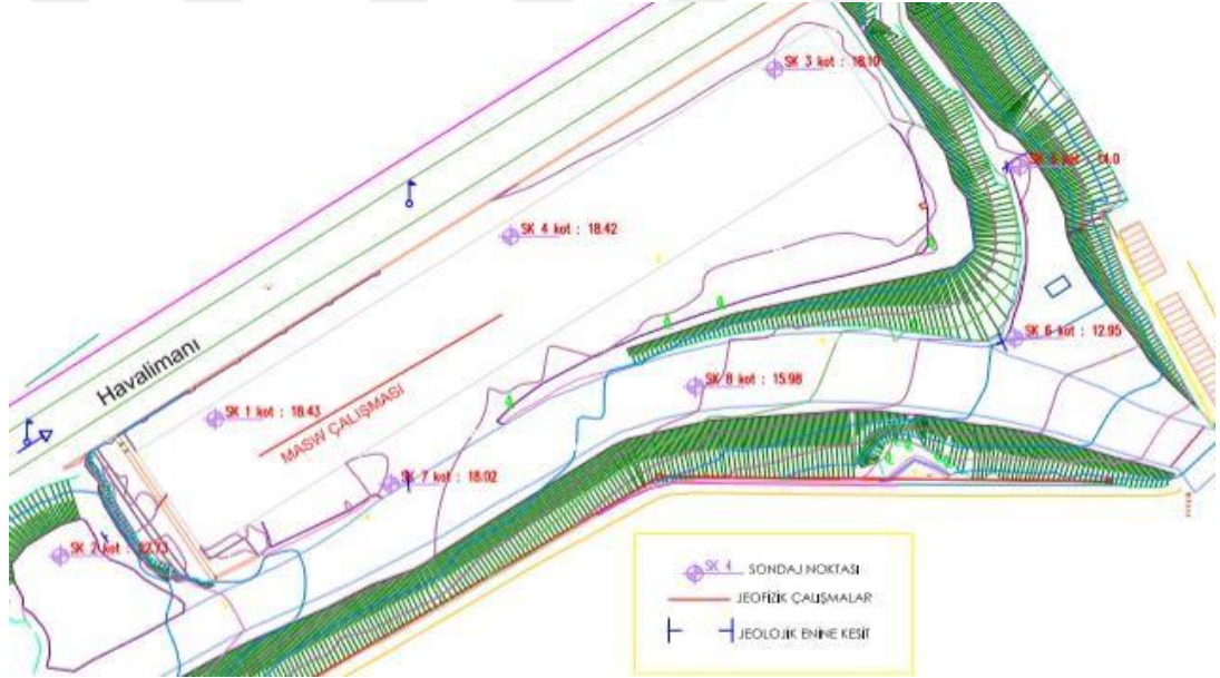
Şekil 3.3 : Zemin Etüd Çalışmalarının Konumları
