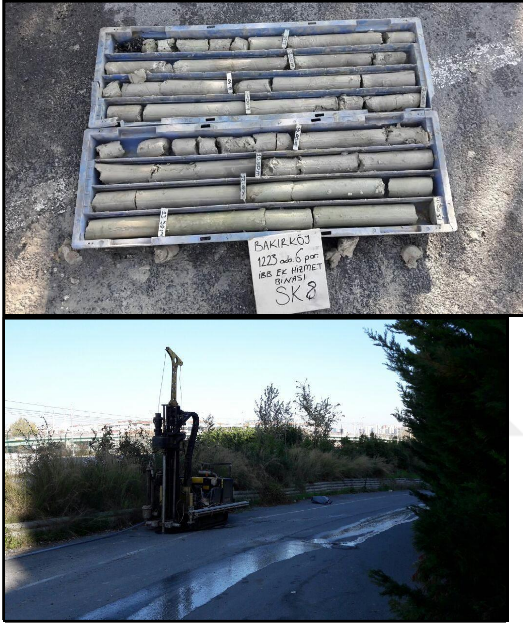
Şekil 3.11: SK 8 sondaj çalışması ve karot sandığından bir görünüm
