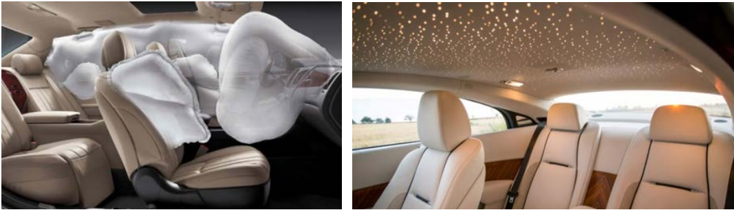
Şekil 2.13: Hava yastığı ve tavan döşemesi [Url-19,20]
