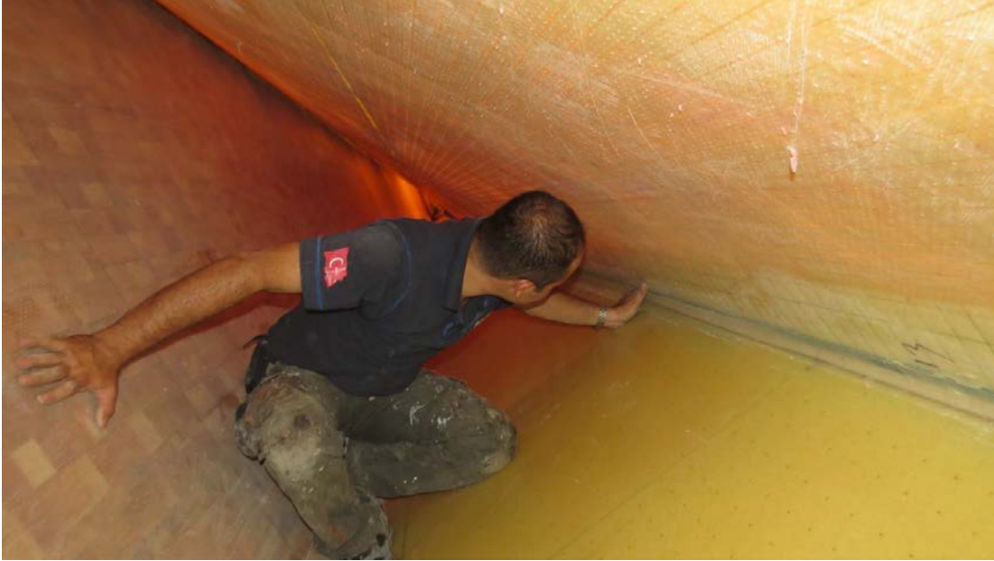
Şekil 4.10 : Kanat İçerisinde Bakım Çalışması
