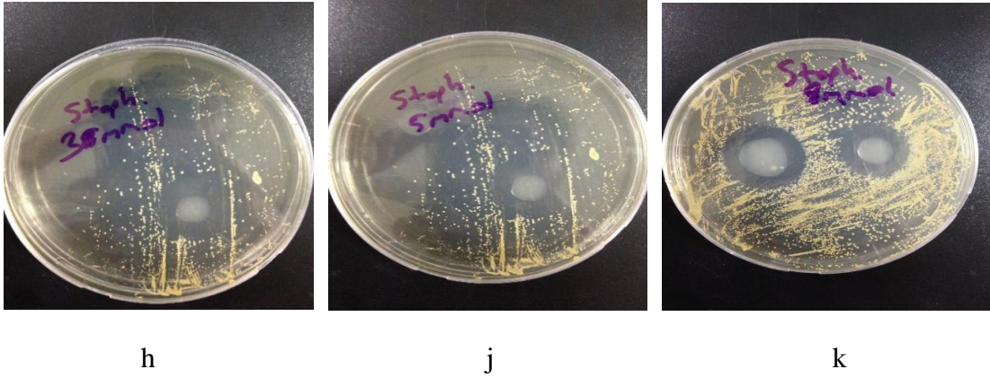
Şekil 4.8: a ve b) MMT, c ve d) HDTBPBr-MMT, e) MN/HDTBPBr-MMT-3, f) 5 ve g) 8 (E. coli bakterisine karşı direnci), h) MN/HDTBPBr-MMT-3, j) 5 ve k) 8 (S. aureus bakterisine karşı direnci)
