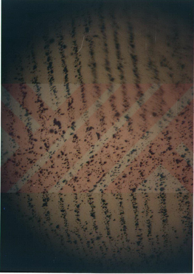
Şekil 3.44 İç zorlu M5 silisyumlu demir alaşımına ait domain resmi.
