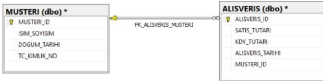
Şekil 2.2: Müşteri ve Alışveriş tablosu arasındaki yabancı anahtar(fk)
