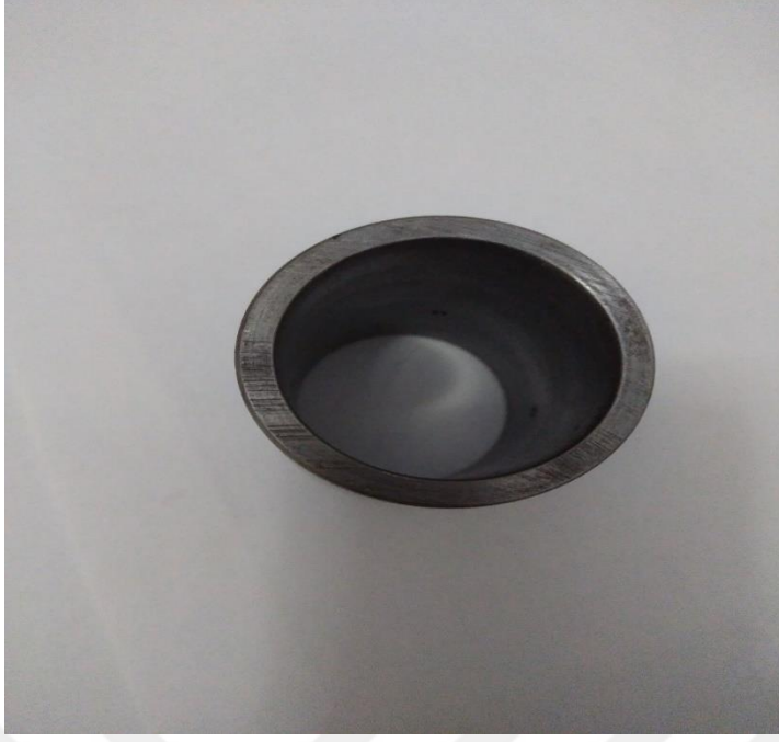
Şekil 5.11: 40 mm'lik deney kalıp parçasının üstten görünümü
