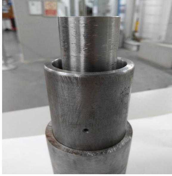
Şekil 5.28: Merkezlemeyi sağlamak amacıyla kullanılan borunun yerleştirilmesi (önden görünüm)
