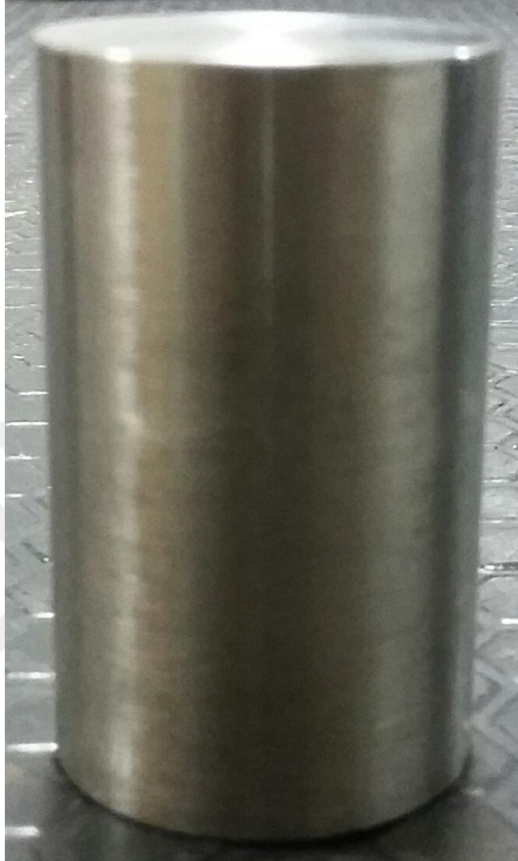
Şekil 5.7: 30 mm'lik deney kalıp parçalarından yük uygulayacak parçanın önden görünümü
