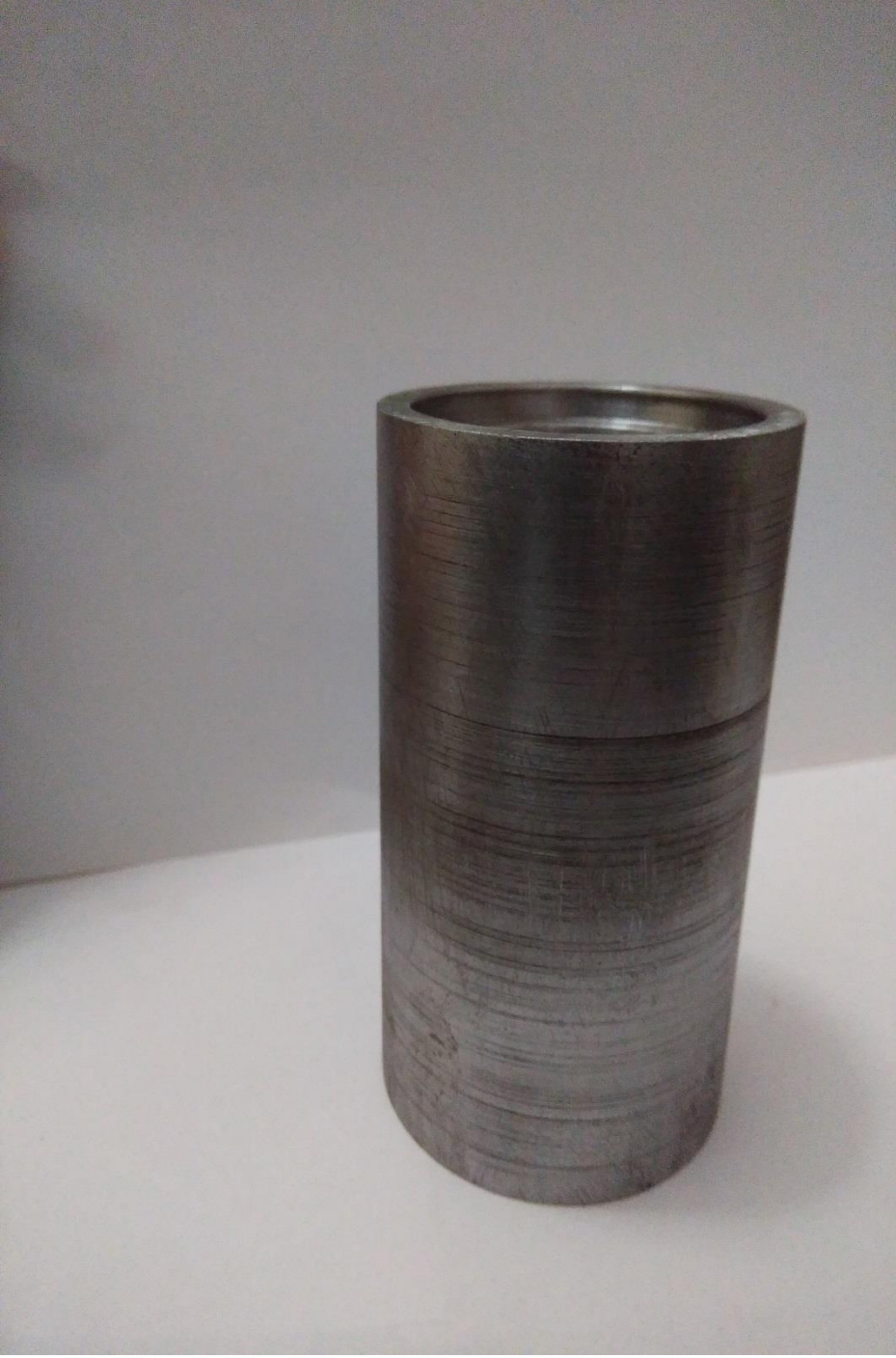
Şekil 5.15: Alt tutucu olarak kullanılacak deney kalıp parçasının yan görünümü Şekil 5.13-5.14-5.15'lerde görüldüğü gibi imalat çeliğinden elde edilen kalıbın alt tutucu görevini üstlenecek malzemelerimiz görülmektedir.
