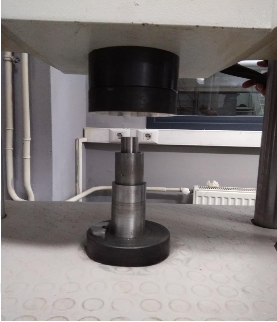
Şekil 5.30: Üst ıstampanın yerleştirilmesi
