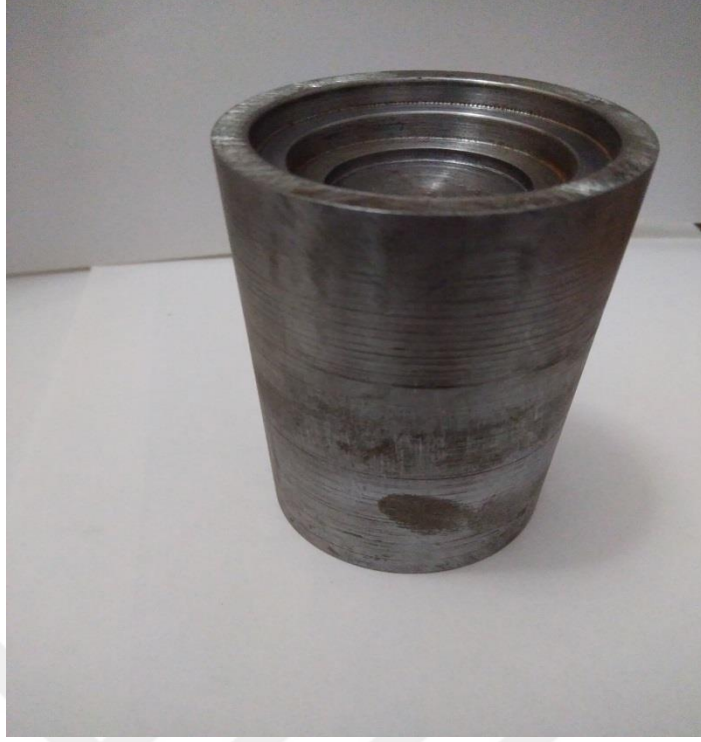
Şekil 5.13: Alt tutucu olarak kullanılacak deney kalıp parçası
