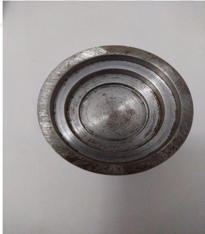
Şekil 5.14: Alt tutucu olarak kullanılacak deney kalıp parçasının üstten görünümü
