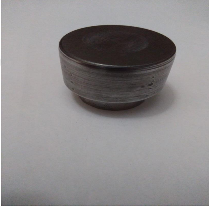
Şekil 5.6: 30 mm'lik deney kalıp parçalarından alt tabanlığın önden görünümü
