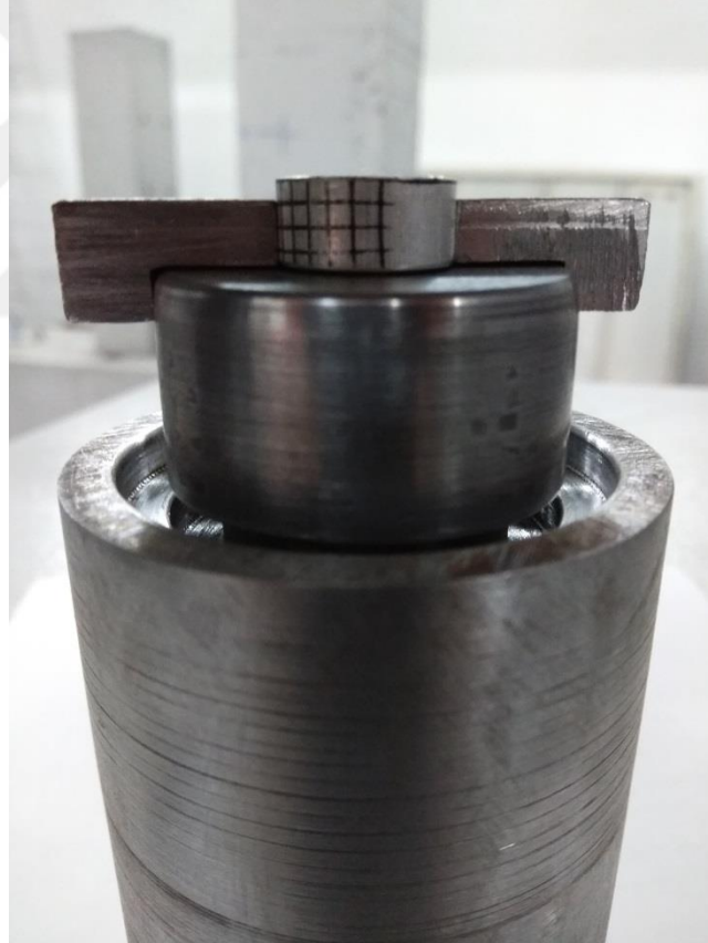
Şekil 5.27: Alt ıstampanın yerleştirilmesi
