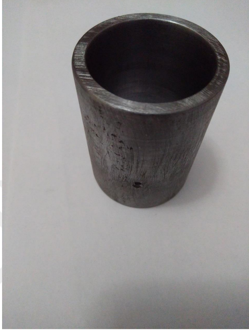
Şekil 5.10: Merkezlemeyi sağlamak amacıyla kullanılan 40 mm'lik çapa, 5 mm'lik et kalınlığına sahip deney kalıp parçası
