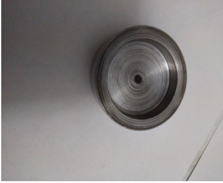
Şekil 5.5: 30 mm'lik deney kalıp parçalarının üstten görünümü
