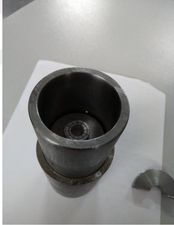
Şekil 5.29: Merkezlemeyi sağlamak amacıyla kullanılan parçanın yerleştirilmesi (üstten görünüm)
