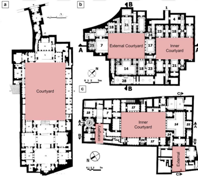
Şekil 4.33: İran geleneksel evlerinin ailelerin maddi ve sosyal statüsüne göre tipik düzenlemeleri, iç, dış ve merkezi avlu gösterimi, a) Kaşan Evi, b) Yazd Evi, c) Yazd Evi (Soflaei, Shokouhian, Zhu, 2017)
