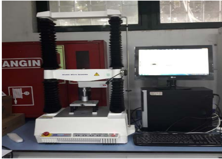
Şekil 9.1: TA-HD plus Tekstür Analiz Cihazı (Stable Micro System.UK).
