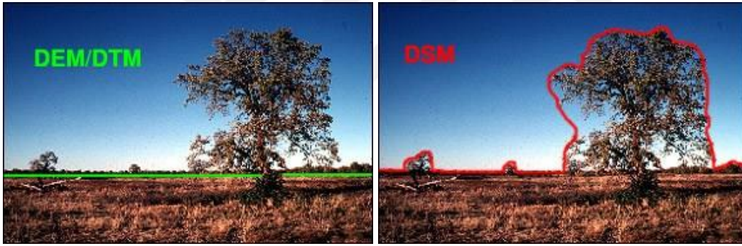
Şekil 2.12: DEM, DTM ve DSM (URL – 4).
