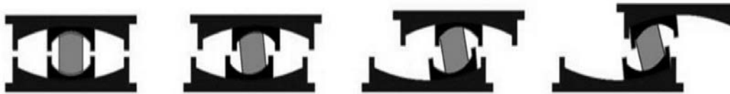
Şekil 2.9: Üçlü Sarkaç mesnetin farklı titreşim aşamaları
