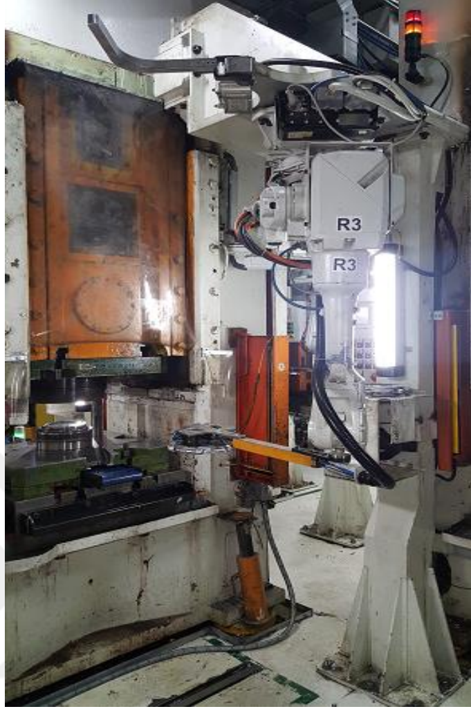
Şekil 3.18: Hidrolik Preslere Robot Kolu İle Besleme
