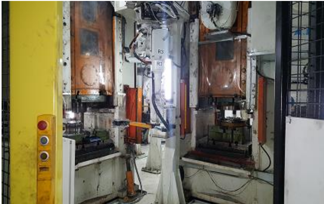
Şekil 3.19: İki Hidrolik Pres Arası Robot Kolu ile Besleme
