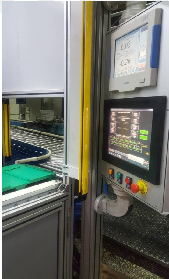
Şekil 3.13: Pres İçin Giriş Kapılarında Işık Bariyerleri, (2016)
