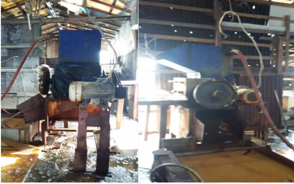
Şekil 3.10: Volanları Korumasız çalıştırılan Plastik Kırma Makinesi
