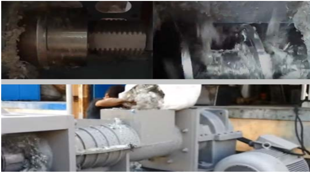
Şekil 2.15: Yatay Plastik sıkma makinesinin kısımları (Yalman, Akata,2019)
