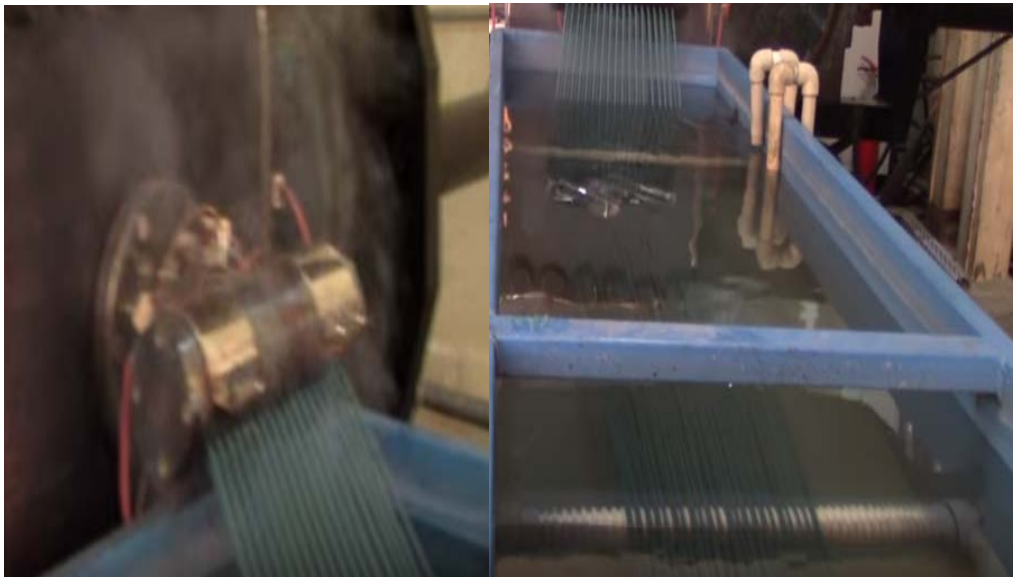
Şekil 2.31: Granül Soğutma Havuzu
