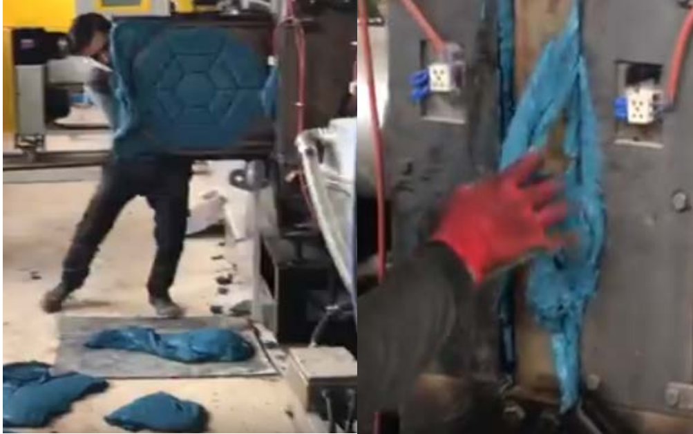
Şekil 2.25: Tıkanmış süzgeç mekanizması ve temizlenmesi
