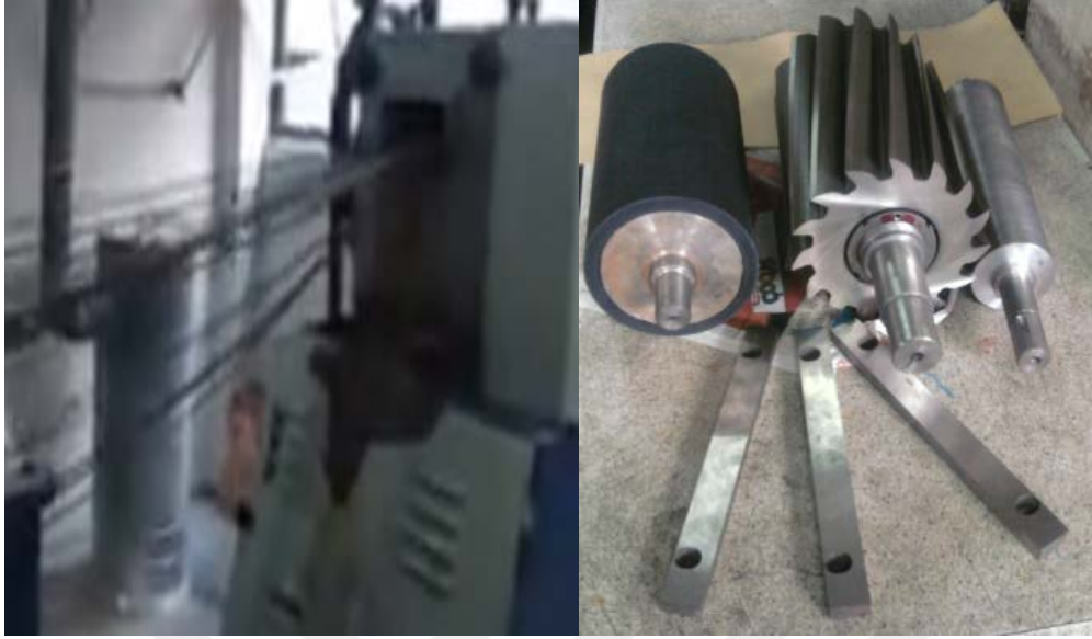
Şekil 2.29: Tesbih Biçimli kesme makinesi ve silindirik bıçak
