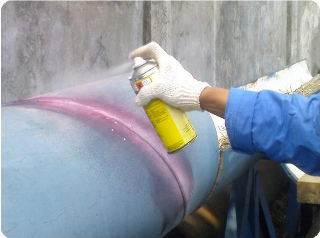
Şekil 4.14: Manyetik penetrant testi örneği
