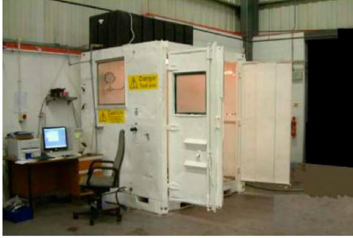
Şekil 4.5: Basınç Testi İçin Dizayn Edilmiş Kabin Örneği
