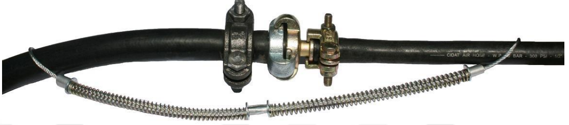
Şekil 4.21: Doğru Whip-Check Uygulaması Örneği
