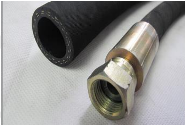
Şekil 4.23: Standartı olmayan güvenliksiz hidrolik hortum
