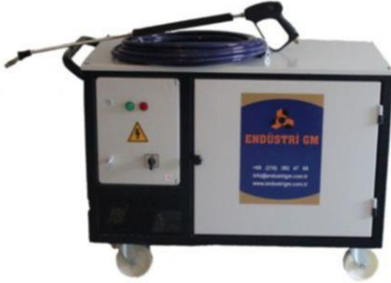
Şekil 4.26: Hidrostatik basınç testlerinde kullanılan su jeti
