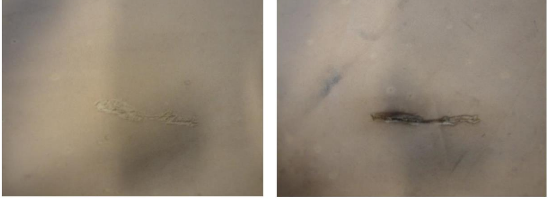
Şekil 4.3: Deney Sonrası Deri Üzerindeki Hasarlar
