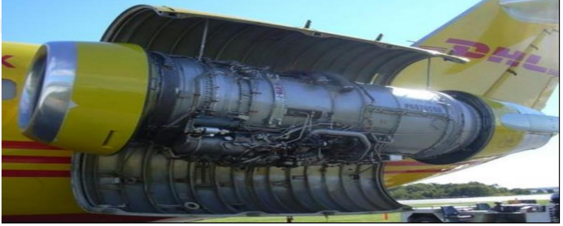
Şekil 2.3: JT8D turbofan motorun ticari uçaklarda kullanımı [27]
