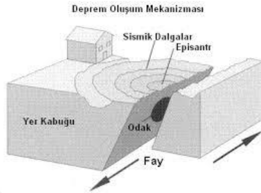
Şekil 2.1: Deprem oluşum mekanizması.
