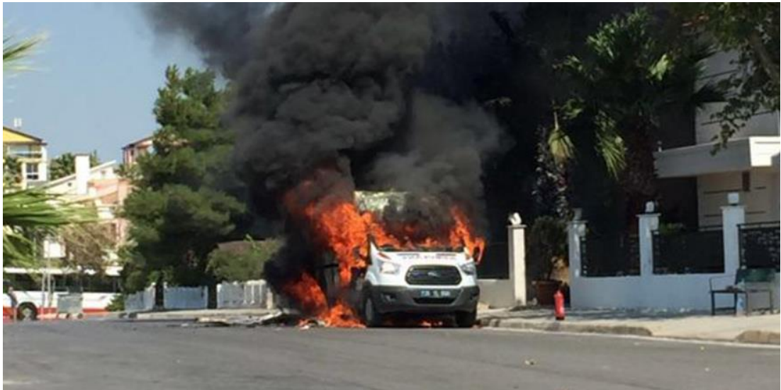
Şekil 3.3: Ambulansta oksijen tüpü patlaması
