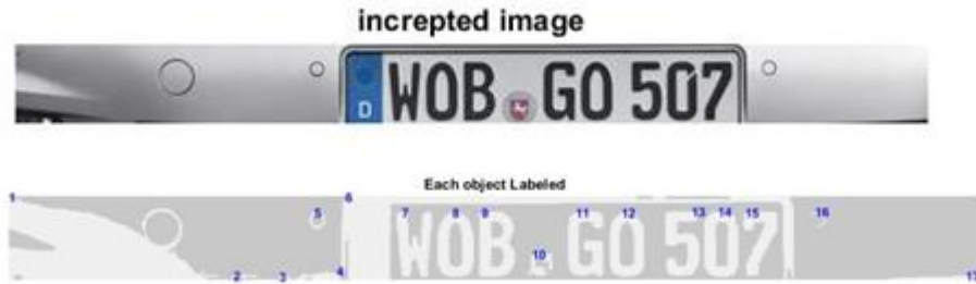
Şekil 5. 6: Örnek Avrupa plakasının yerelleştirilmesi.
