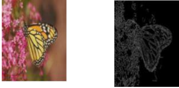
Şekil 2. 11: Görüntüye Canny filtre uygulanması
