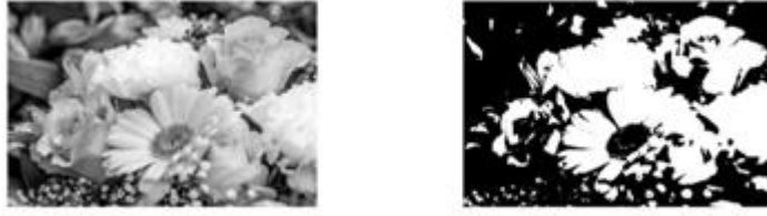
Şekil 2. 2: Görüntünün iki sayılı resme dönüştürülmesi.
