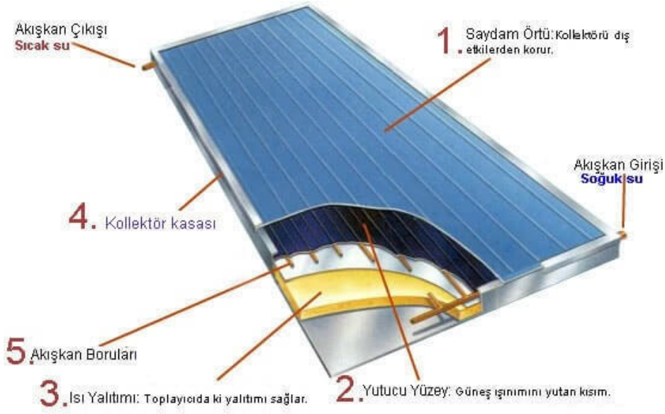
Şekil 2.2: Örnek bir düz yüzeyli kollektör (Tesisat, 2019)
