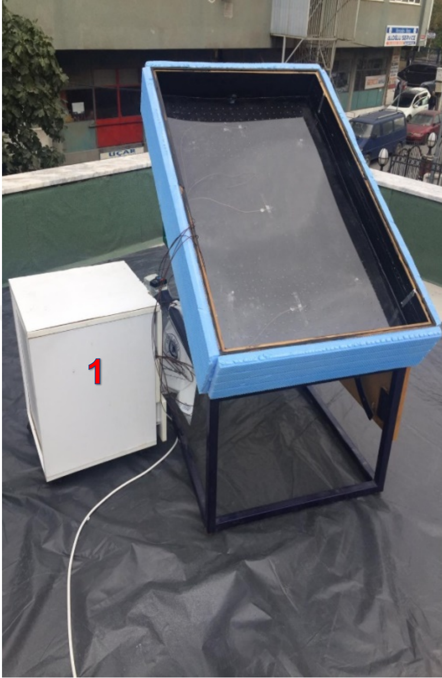
Şekil 3.2: Yapılan Çalışmaya Ait Kollektörün Data Loger İle Üst Görünümü
