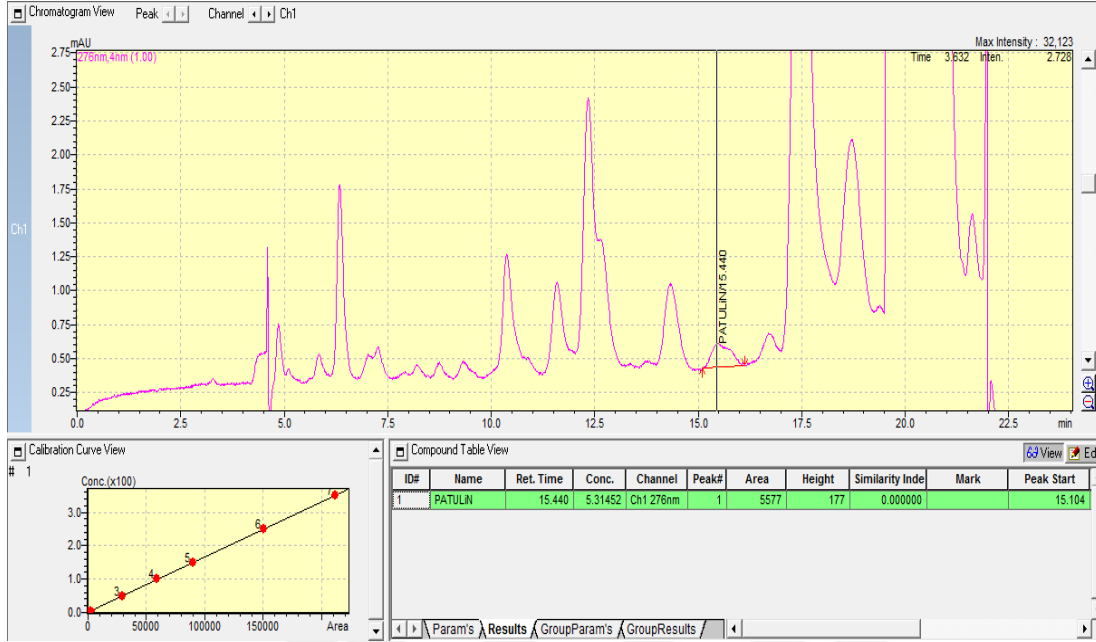
Şekil 6.7: 5,31 µg/L konsantrasyonda Patulin tespit edilmiş olan sirke (Örnek-3) örneğine ait kromatogram.
